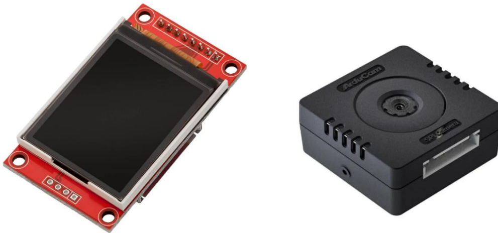
Figura 9.1 – Un display LCD cu SPI (stânga) și un modul de cameră foto SPI (dreapta)
