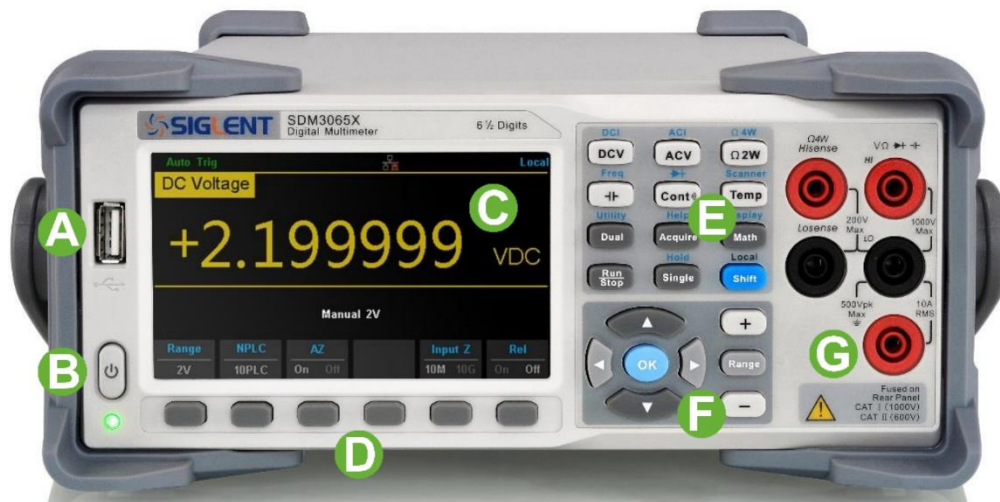
Figura 1.9 - Panoul frontal al multimetrului digital SDM3065X
