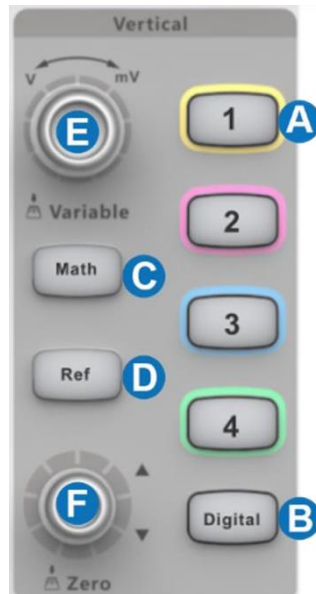
Figura 1.14 - Butoanele de control vertical pentru SDS2000X Plus
