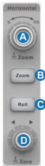
Figura 1.15 - Butoanele de control orizontal pentru SDS2000X Plus
