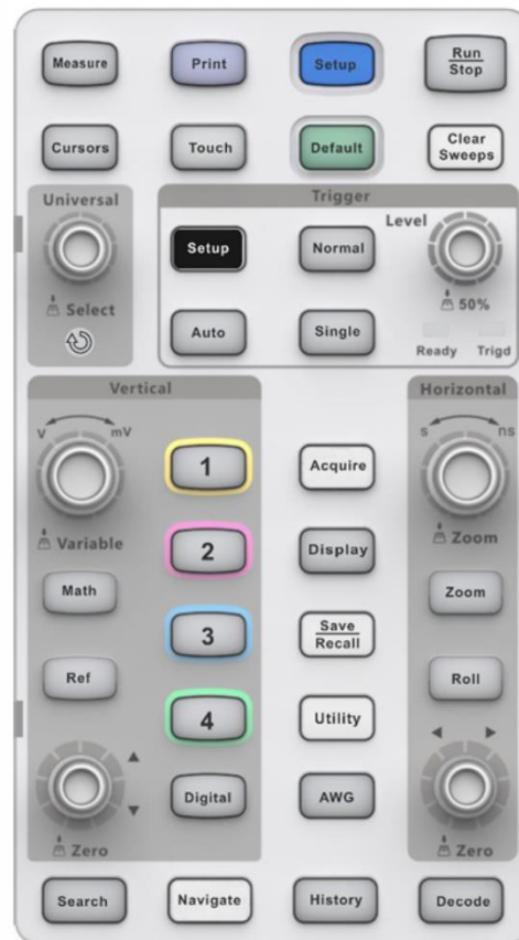
Figura 1.12 - Panoul frontal cu butoane pentru SDS2000X Plus
