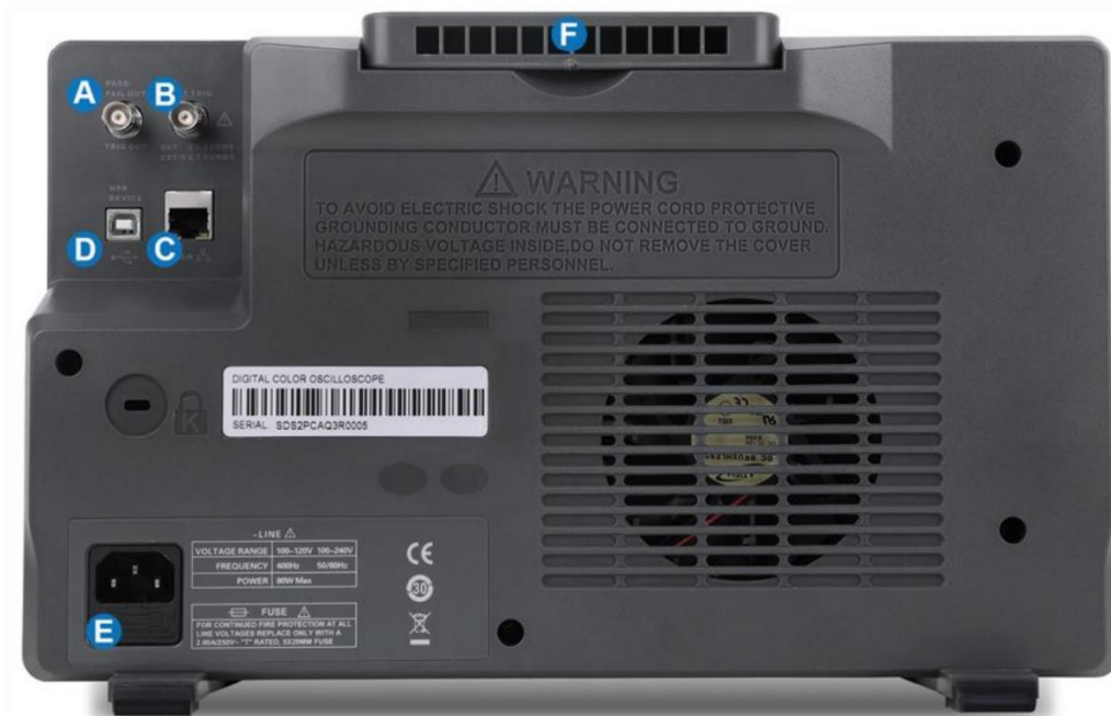
Figura 1.13 - Panoul posterior al osciloscopului digital SDS2000X PLUS
