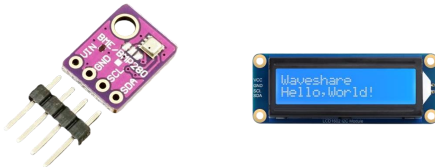
Figura 10.1 – Un senzor I 2 C de presiune și umiditate (stânga) și un display I 2 C LCD (dreapta)
